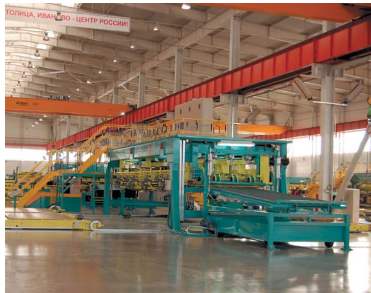
Новый производственный комплекс, на первом плане – испанская линия поперечной резки рулонной стали FAGOR
