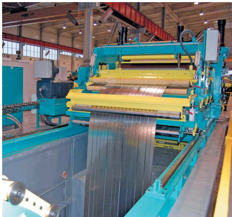
Немецкая линия продольной резки рулонной стали GEORG
